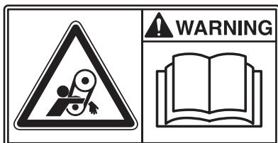
Ременный привод: не допускайте касания руками, инструментами и другими предметами ременного привода включенной виброплиты. Это позволит избежать травмы и повреждения оборудования. См. инструкции по обеспечению безопасности в руководстве.
