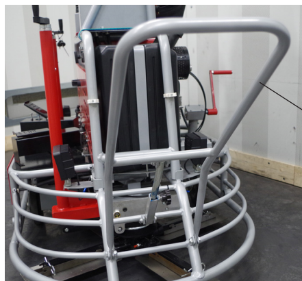
Handtag, förflyttning i utfälld läge.
