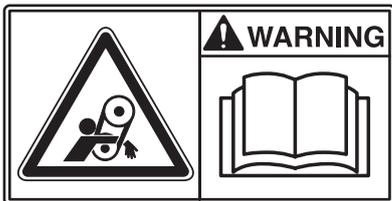
Riemenantrieb: Wenn die Maschine eingeschaltet ist, halten Sie Hände, Werkzeuge oder andere Gegenstände vom Riementrieb fern, um Verletzungen zu vermeiden. Siehe auch die Sicherheitsanweisungen im Handbuch.
