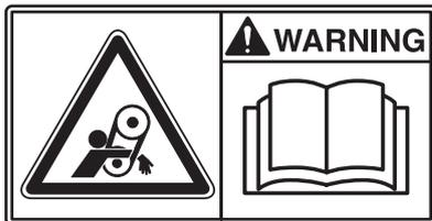
Riemenantrieb: Wenn die Maschine eingeschaltet ist, halten Sie Hände, Werkzeuge und andere Gegenstände vom Riementrieb entfernt, um Verletzungen und Schäden zu vermeiden. Siehe auch die Sicherheitsanweisungen im Handbuch.
