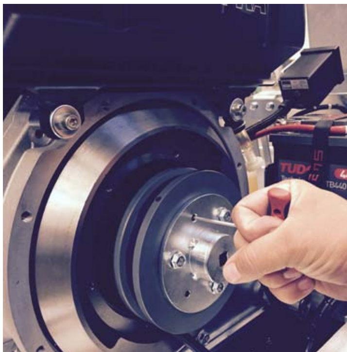
Povolte tři nastavovací šrouby (jak je znázorněno)
