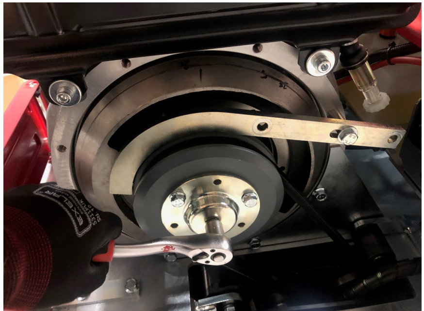
Börja med att lossa tre stoppskruvar både vid lossning och spänning av remmen (enligt bild)
